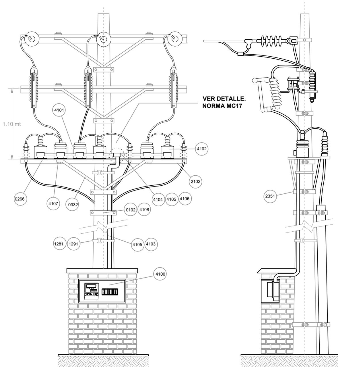
**NOTAS:** Montaje de medida indirecta, con caja de medidor instalada en murete de concreto o ladrillo
